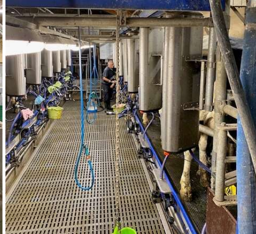
Mjölkkaren står i en nedsänkt "grop" för att få en bra arbetshöjd vid mjölkningsarbetet (korna till höger här)
