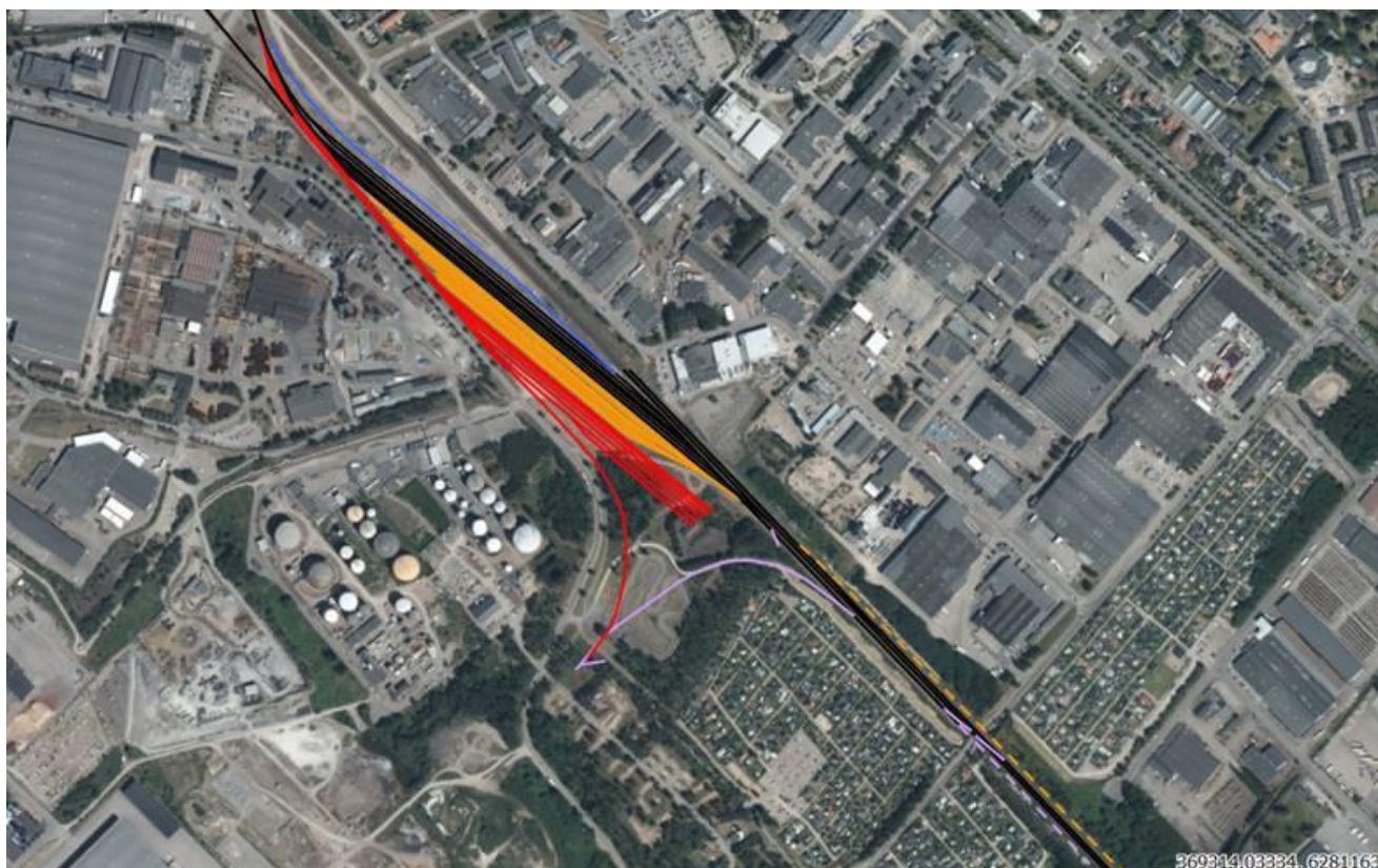
Bild 1 visar föreslagen uppställningsbangård (de raka, rödmarkerade spåren söderut), föreslagen godsbangård (orange- resp. svartmarkerade spår) och föreslaget nytt hamnstamspår (delvis röd- och delvis lilamarkerat spår). Åtgärden som häri föreslås avser de rödmarkerade spåren
