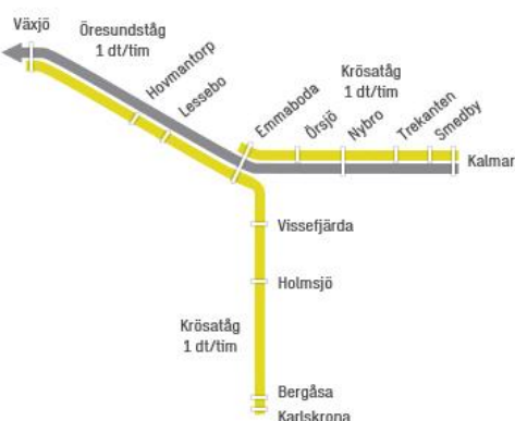
Figur 30: Schematisk skiss över tågtrafiksystemen mellan Växjö, Kalmar och Karlskrona. Grunden är att Öresundståg behöver parallell lokaltågtrafik, i form av Krösatågen, även på sträckan Växjö-Emmaboda, för att bli snabbare. Hypotetiskt kan alternativt antingen Krösatåglinjen från Kalmar eller Karlskrona förlängas till Växjö.
