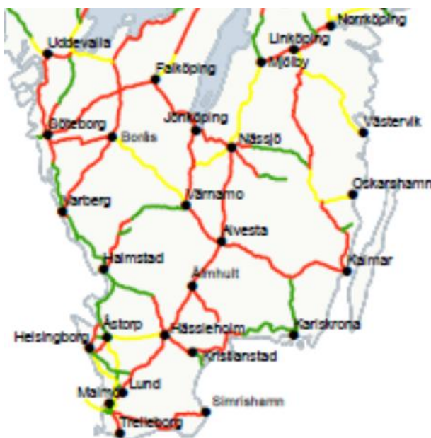
Figur 20: Kapacitetsutnyttjande under högtrafik 2019. Grönt – lågt utnyttjande, gult – medelhögt utnyttjande, rött – mycket högt utnyttjande. Källa: Trafikverket.
