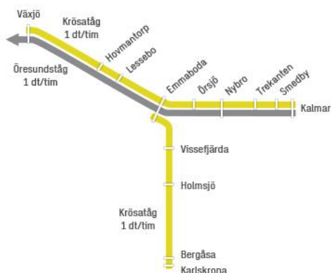
Figur 30: Schematisk skiss över tågtrafiksystemen mellan Växjö, Kalmar och Karlskrona. Grunden är att Öresundståg behöver parallell lokaltågtrafik, i form av Krösatågen, även på sträckan Växjö-Emmaboda, för att bli snabbare. Hypotetiskt kan alternativt antingen Krösatåglinjen från Kalmar eller Karlskrona förlängas till Växjö.
