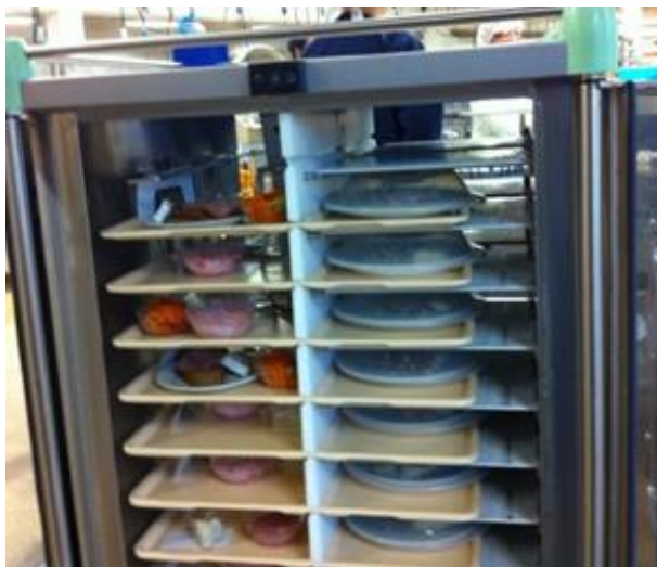
Figur 2. Matvagn med en kylsida och en varmsida för leverans av Frukost, Middag respektive Kvällsmat till avdelningarna.
